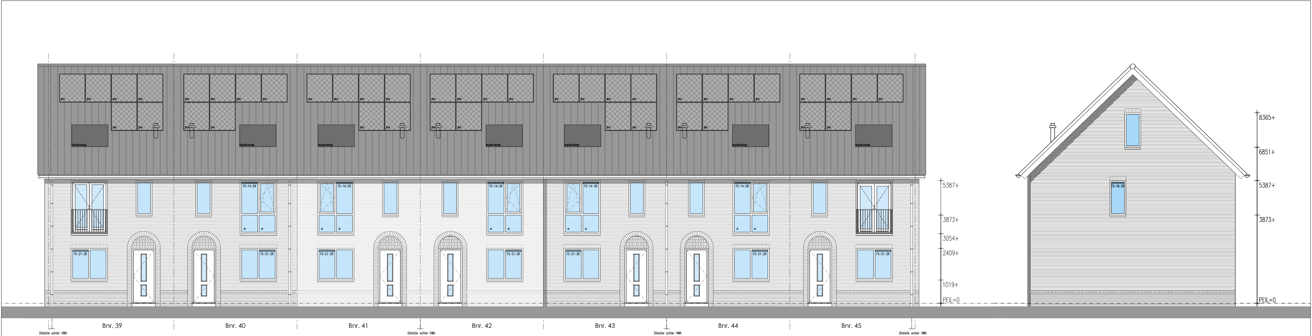
Voorgevel * = doorvalveilig glas
